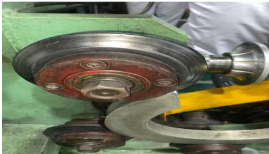
Gambar 2. Rubber Wheels yang sudah diganti
